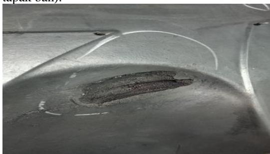
Gambar 3. Contoh Jenis Defect CB (*Crown bare*)
