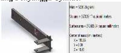
Gambar 42. Simulasi *Solidwork* Batang Penyangga *Cylinder*
