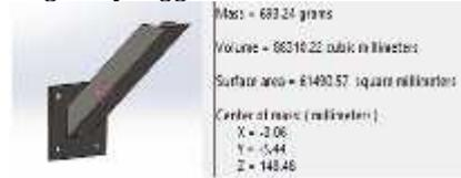
Gambar 43 Simulasi *Solidwork* Batang Penyangga Rel dan *Bucket*
